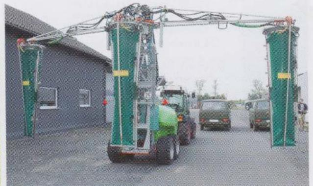
Kisten aus Holz (Bild links) sind robuster und bei der Entsorgung weniger schädlich für die Umwelt als Behälter aus Kunststoff. Die „Drei-Reihen-Spritze“ (Bild rechts) verkürzt die Wege, da sie gleich drei Baumreihen auf einmal behandelt.
